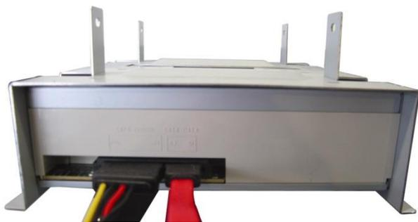
Шаг 5: Установите и зафиксируйте кронштейн в корпусе DVR.
